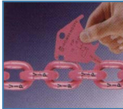
Inspección del desgaste del diámetro nominal
