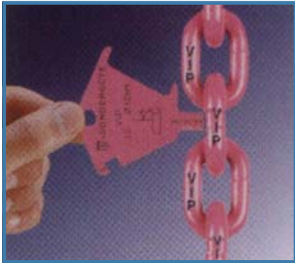
Inspección del alargamiento del paso debido al desgaste del diámetro nominal.
